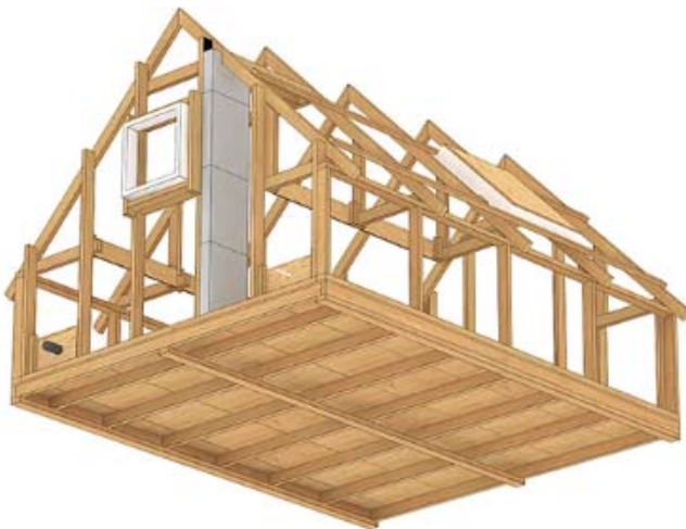
Figur 5. Gulvkonstruktion set nedefra. Bredde 3220 mm. Længde: 4000 mm.
