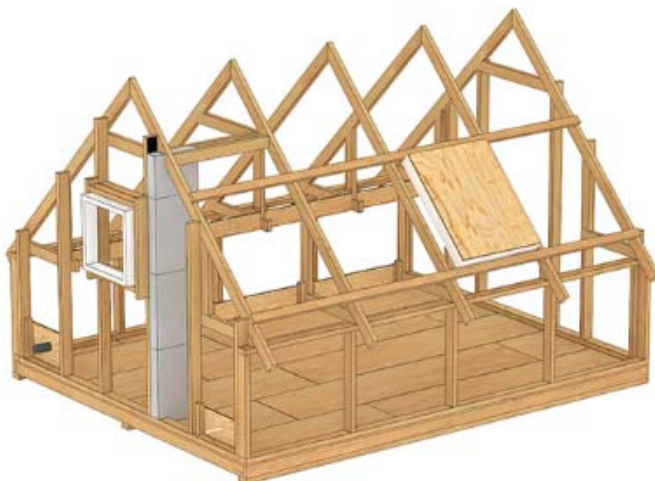
Figur 6. De 2 bageste hanebånd er afskåret, så dampspærren her føres til kip. Samling mellem gulvplader skal tætnes, fx med dampspærretape og eventuelt med membran. Gavlvinduet er placeret i en lysning, der fremkommer ved 95 mm udlægning.
