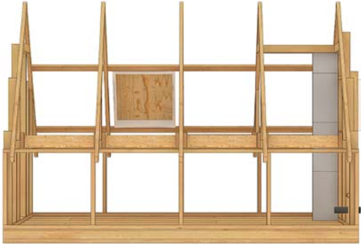
Figur 1. Facade 4 m. Tagflade uden ovenlys. Hanebånd i spær 2 og 3 venstre fra venstre afskåret, så der her udføres dampspærre til kip. 900 mm fra underside bundrem til overside toprem i væg.
